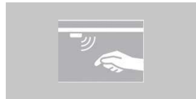
Iluminación LED MÓDULO CON SENSOR DE PRESENCIA
