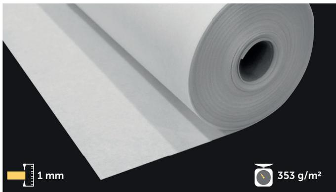
DYSO es una lámina flexible para la desolidarización bajo cerámica en espacios interiores y exteriores. Especialmente diseñada para su instalación bajo piezas de gran formato y sobre suelo radiante. Compuesta por una capa de elastómero construida en forma de célula cerrada, de manera que absorbe los movimientos horizontales del soporte. Recubierta de fibras de polipropileno, para el óptimo agarre con el cemento cola C2 S1, usado en su instalación como lámina adherida.
