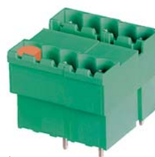
pas 10/10.16 mm de 2 à 25 pôles version droite, détrompée
