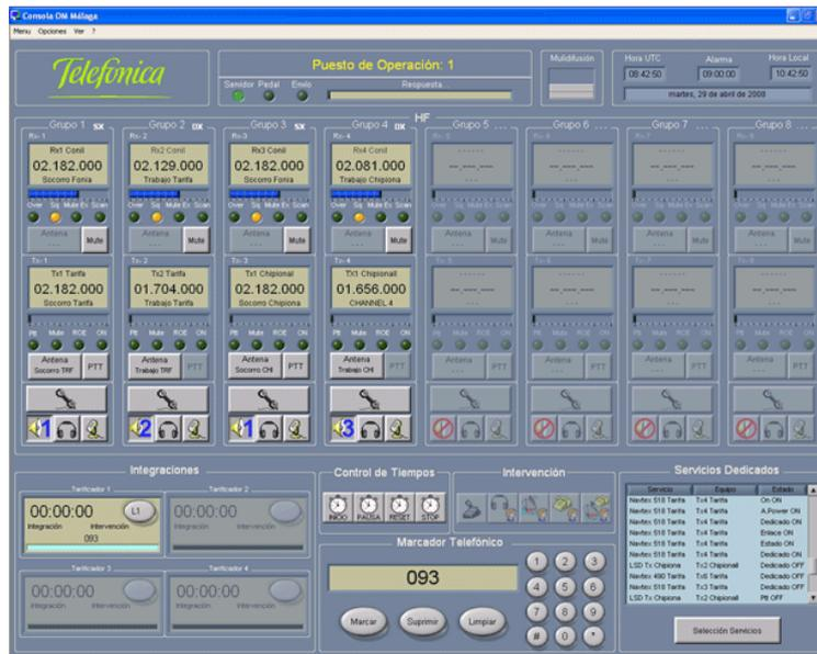
El puesto de operación forma parte de un sistema de comunicaciones, regido por un servidor encargado de controlar los distintos equipos que componen el sistema. El enlace entre el servidor y el puesto de operación se efectúa mediante red Ethernet. El programa puede controlar hasta un máximo de 8 grupos de HF, compuestos por un receptor, un transmisor y 4 líneas telefónicas.
