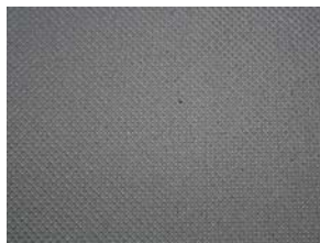
External coating with adhesive thermoacoustic insulating polyethylene. Recubrimiento externo con aislante adhesivo termoacústico de polietileno.
