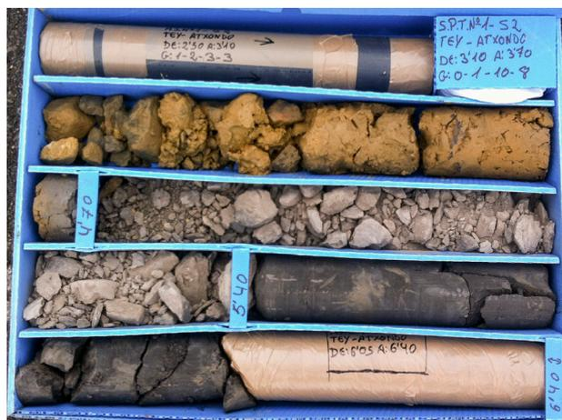
Muestras inalteradas y parafinadas obtenidas mediante sondeo mecánico a rotación
