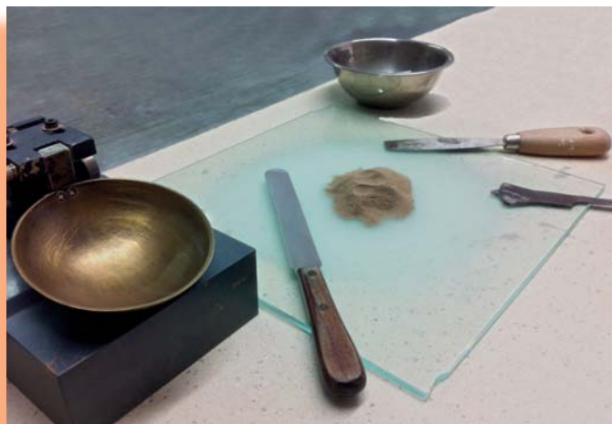
El ensayo de determinación de Límites de Atterberg se utiliza para caracterizar el comportamiento de los suelos finos
