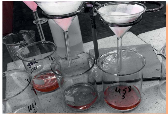
El ensayo de determinación del contenido en sulfatos permite averiguar si la composición química de un suelo en contacto con los hormigones podrá ser perjudicial, degradando así las cimentaciones
