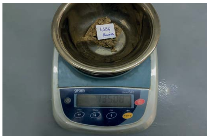
El contenido en humedad natural es una relación gravimétrica existente entre el peso del agua y el peso de los sólidos en un volumen dado de suelo
