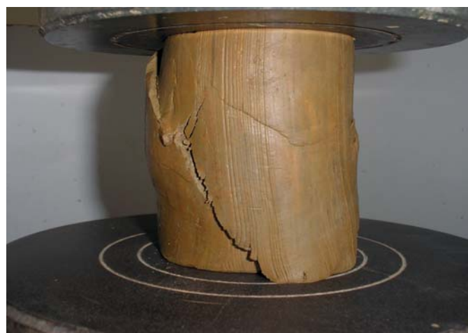
El ensayo de compresión simple de un suelo permite obtener un valor de carga última del suelo
