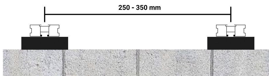
Separación entre rastreles
