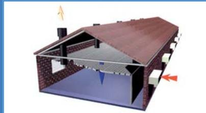
Unidades no autónomas desprovistas del grupo motoventilador. Se instalan adosadas a la pared del recinto, introduciéndose el aire refrigerado a través de ellas por la depresión causada por ventiladores de extracción.
