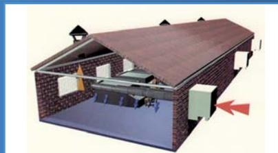
Unidades adecuadas para grandes espacios en los que se necesite una distribución por conductos. Incorporan ventilador centrífugo. Se montan tanto sobre la cubierta del recinto como adosadas a las paredes de cerramiento. El aire es introducido en el recinto a través de tubos de distribución, siendo impulsado por su ventilador centrífugo.
