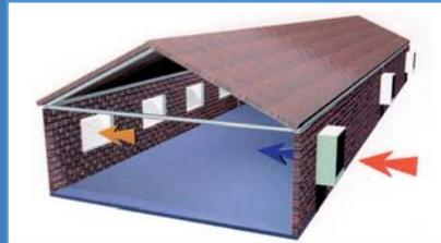
Unidades adecuadas para la configuración en sobrepresión. Se montan adosadas a las paredes de cerramiento del recinto, introduciendo horizontalmente el aire refrigerado. Cada unidad incorpora su propio equipo motoventilador.
