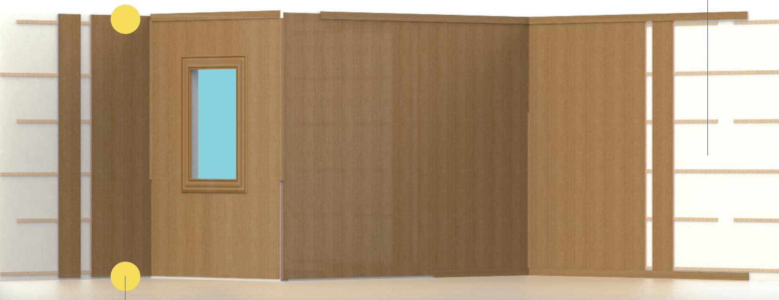
Para la posible acumulación de humedad en la cámara interior recomendamos colocar alguna rejilla de ventilación en la parte de arriba o de abajo.
