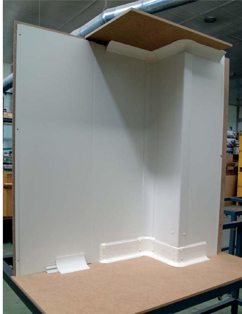
Repitiendo la misma operación a ambos lados de la cantonera, y arriba y abajo (dependiendo de la altura del montaje, pondremos tantos tacos como fuera necesario), daríamos por concluído este supuesto montaje.
