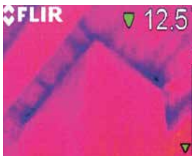
Passaggi incontrollati d'aria dovuti alla mancata sigillazione, rilevati con termocamera a raggi infrarossi
