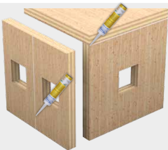
Sigillatura della giunzione tra due pareti in legno e tra pareti e solaio in legno
