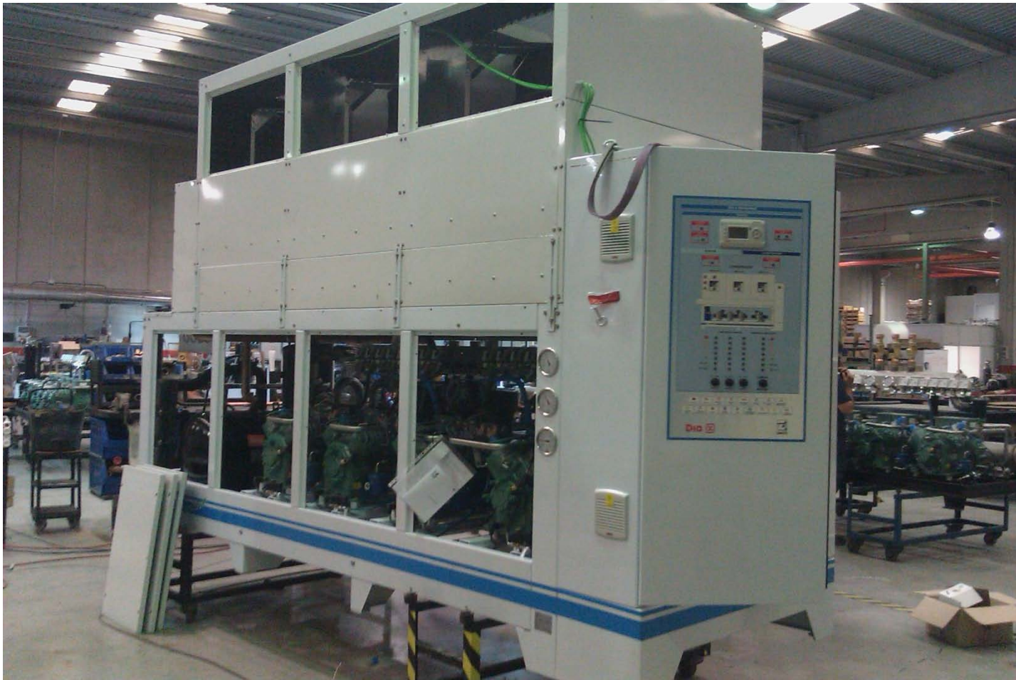
CENTRAL CARROZADA SUPERMERCADO CON CUADRO ELÉCTRICO INCORPORADO
