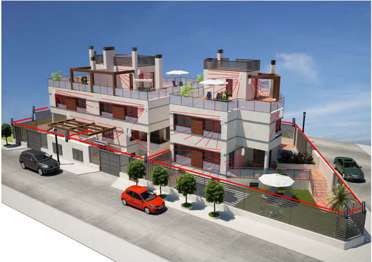
Fachada delantera. Esquema instalación seguridad
