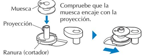
\* Compruebe la orientación de instalación de la bobina utilizando, como referencia, la marca "b" que aparece en un lado de la bobina. Cuando coloque la bobina en la caja de la bobina, compruebe que la orientación sea la misma.
