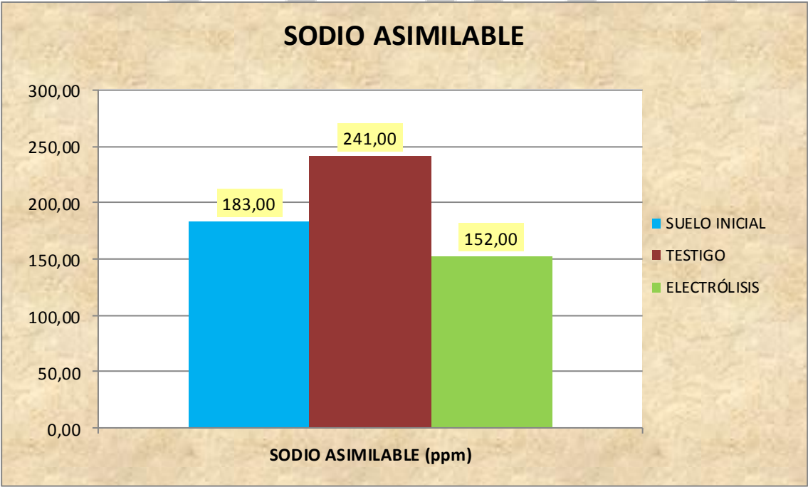
Figura nº 18 COMPARATIVA SODIO ASIMILABLE DE SUELO INICIAL Y SUELO FINAL TESTIGO Y ELECTRÓLISIS
