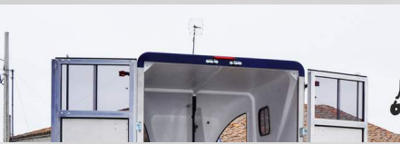
(9) Ventanas correderas en puertas traseras
