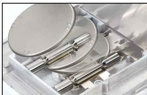
El sistema de calibración interna AutoCal™ calibra automáticamente la balanza cuando ésta detecta un cambio de temperatura lo suficientemente amplio para que éste afecte a la exactitud de las pesadas.
