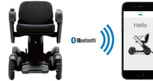
Bloquear / desbloquear y administrar la configuración de velocidad a través de la aplicación de iPhone y Android. Además permite conducir mediante control remoto con la aplicación de iOS.
