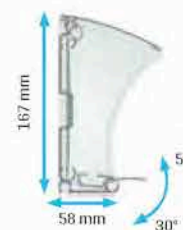
INCLINACIÓN DO TOLDO DE 5° A 35° / AWNING INCLINATION FROM 5° TO 35°
