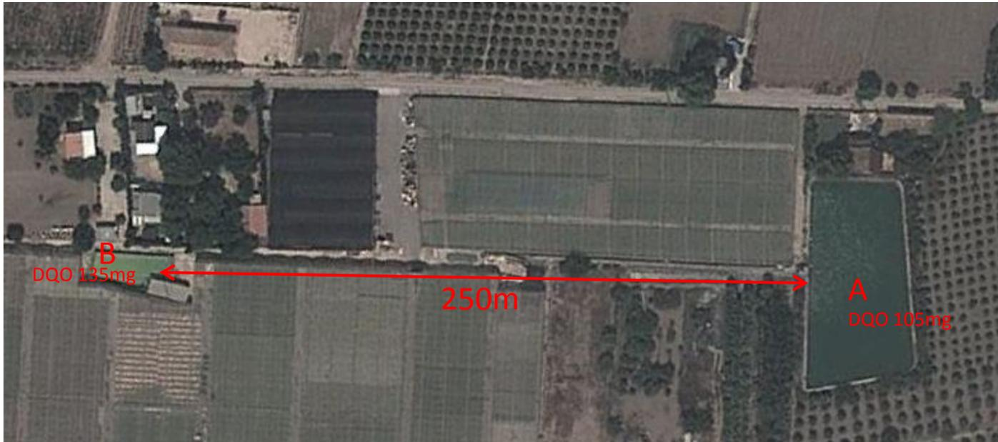
Un embalse con una capacidad aproximada de 12.000 m<sup>3</sup> de agua (A), proveniente del río segura, en su tramo final, con una DQO de 105mgO<sub>2</sub>/L y que suministra a un segundo embalse de unos 500m<sup>3</sup> (B), este embalse con unos valores en DQO de hasta 135mgO<sub>2</sub>/L.
