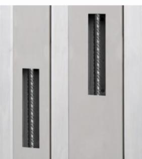
La puerta está fabricada en su interior con omegas, barras estabilizadoras en forma de doble U y reforzada con barras de tetracero en el interior de estas lo que impide el acceso a la vivienda por medio del butrón.
