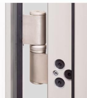
Tres bisagras fabricadas en exclusiva para la Premium 4C con 6 mm de espesor en acero, con un nudo de 115x30 mm, rodamientos y regulación.
