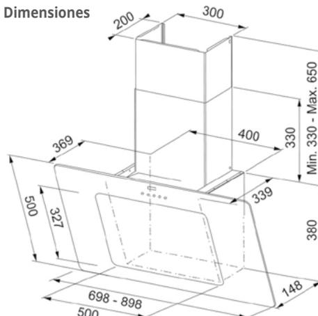
Se recomienda una instalación mínima a 47 cm sobre la zona de cocción. Doble sistema de aspiración: perimetral y adicional en la zona inferior.
