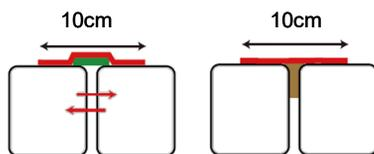
En juntas con mucho movimiento, aplicar primero una Cinta Effisus 2Bond DS. Aplicar normalmente sobre la Cinta Effisus 2Bond DS la Membrana Effisus Easyrepair. La combinación de los dos materiales, tiene una mayor capacidad de absorción de movimientos.
