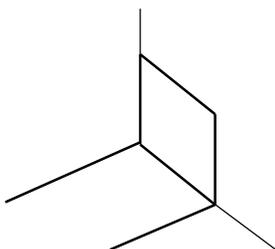
Nunca estirar la Membrana Effisus Easyrepair con la intención de que esta se ajuste a la esquina. Dejar que se una ajustando la membrana sin tensiones.
