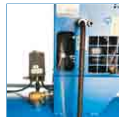
Secador preinstalado y conectado
