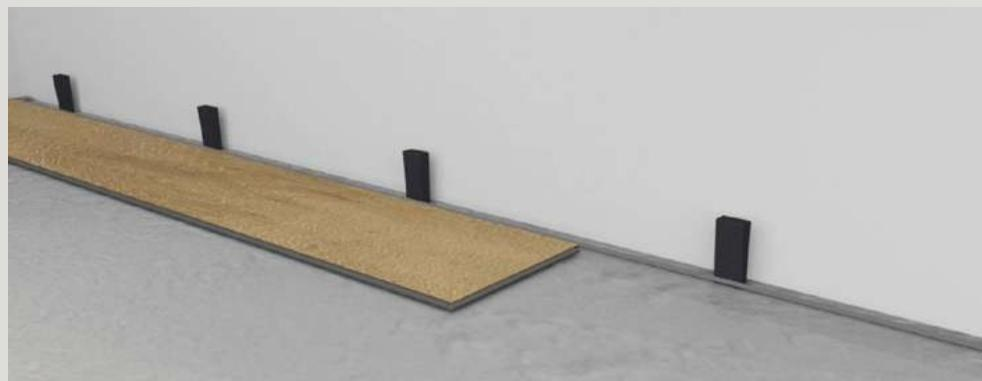
Coloque la primera tabla de forma que la lengüeta del click quede mirando en dirección contraria a la pared. / *Place the first plank so that grooved edges are facing away from the walls.*
