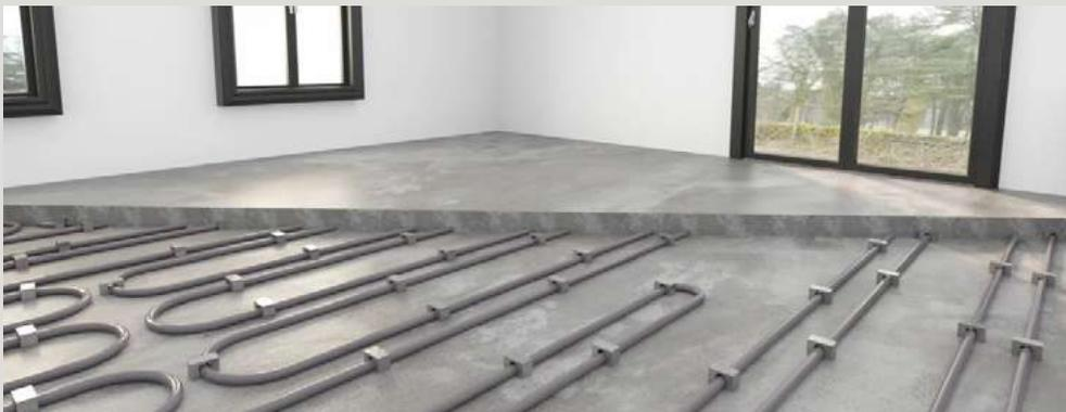
Los sistemas de calefacción deben estar instalados a un mínimo de 12mm. de separación con el producto. La temperatura no debe exceder nunca los 30°C. / *Embedded radiant heat systems must have a minimum of 12 mm. separation from the product. Maximum operating temperature should never exceed 30°C.*
