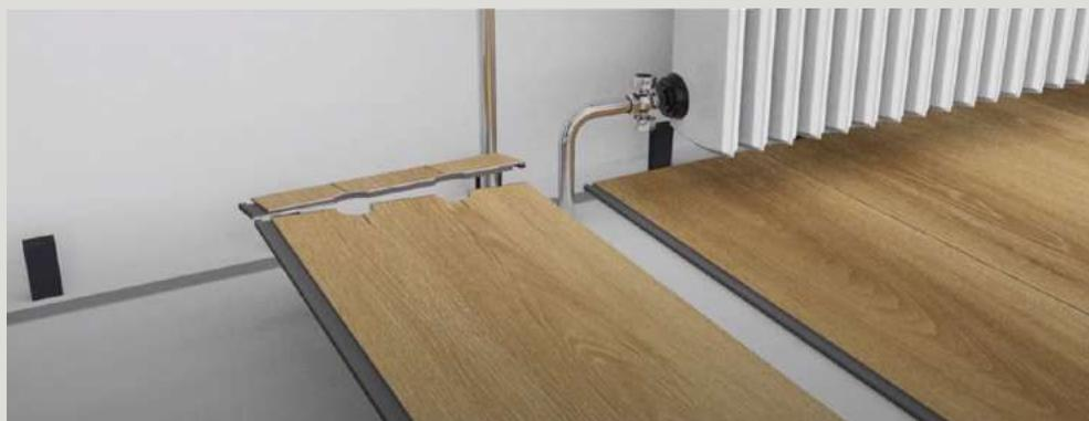
Tuberías: Mida el diámetro y perfore un agujero 12mm. más grande. Corte un trozo, y ponga la pieza recortada en su lugar. / *Holes for pipes: Measure the diameter of the pipe and drill a hole that 12mm/1/2" larger. Saw a piece and lay the plank in place on the floor. Then lay the sawed piece in place.*
