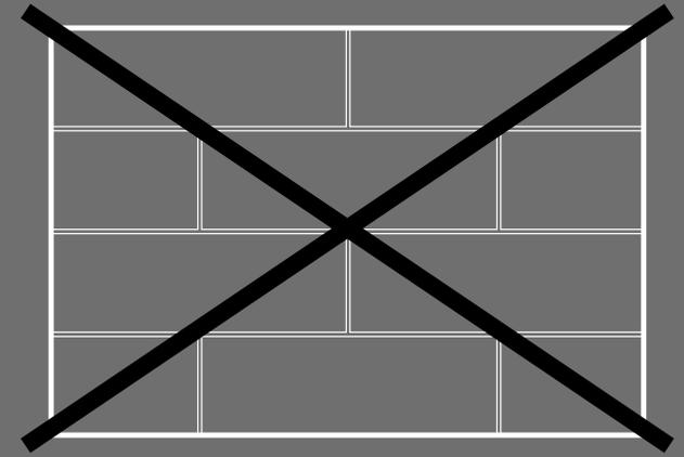
No colocar a junta trabada mayor del 25% para evitar la aparición de cejas. No se aceptarán reclamaciones de material colocado a junta trabada mayor del 25%.
