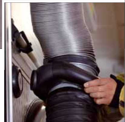
Cuando está activado, el electroimán de la manguera se fija a un plato de anclaje en el vehículo.
