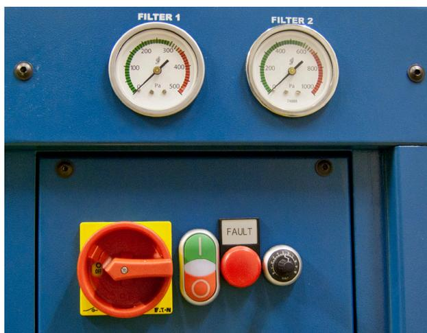
El FilterBench está equipado con manómetros que indican con claridad el momento de reemplazar los filtros.
