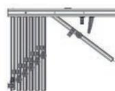
Sistema de fijación de paneles mediante clipaje para agrupar todas las hojas cuando las plegamos manteniéndolas siempre unidas.
