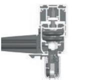
Regulación altura del vidrio en la guía superior mediante compensador con regulación de hasta 2,5 cm.
