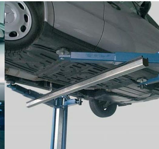
Adaptador de seguridad para el clase A, montado debajo del vehículo en dirección transversal, evita la inclinación del mismo cuando se sacan partes pesadas del vehículo
