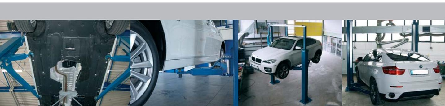
Los brazos de elevación cortos 2 veces telescópicos (DT) permiten elevar una gama más amplia de vehículos y simplifica la elevación de los vehículos cortos y anchos
