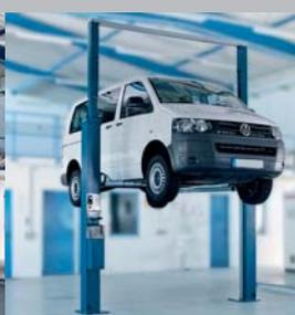
Bloqueo automático del brazo de elevación engranajes finos, posible liberación manual
