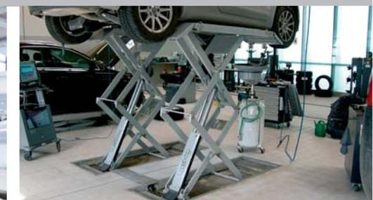
JUMBO LIFT NT 4000 – elevación de vehículo VW T5 con batalla corta y vehículos similares / instalación empotrada
