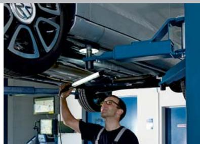
SMART LIFT 2.30 SL DT – brazo de elevación corto es 2 veces telescópico, permitiendo un ajuste de una gran gama de vehículos y simplifica el levantamiento de vehículos más cortos y más anchos
