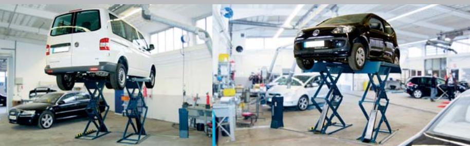
JUMBO LIFT 3500 NT – elevación desde el VW Up hasta VW T5, con batalla corta, sin problemas
