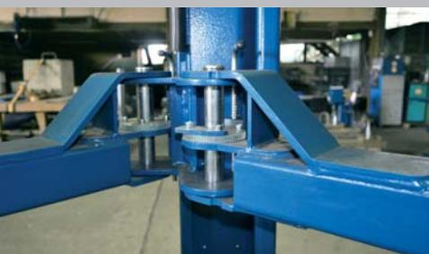
Bloqueo automático del brazo de elevación por engranaje, posibilidad de liberación manual.
