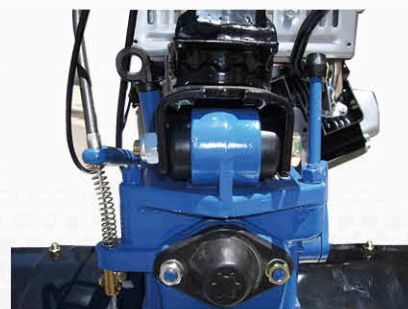
Sistema amortiguación Amortiguadores en la base del manillar para reducir las vibraciones al operario.
