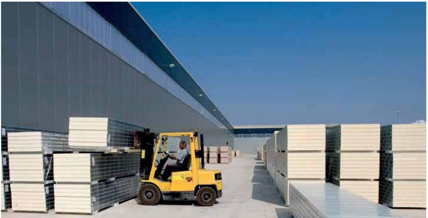
El ciclo de producción de Isopan está en perfecta sintonía con el medioambiente: los paneles están compuestos por un soporte metálico y por una capa de masa aislante de poliuretano o lana mineral, están realizados a través de plantas innovadoras con el fin de reducir el impacto con el medioambiente en el proceso productivo. Además todas las fábricas Isopan en el mundo están equipadas con instalaciones fotovoltaicas con el fin de producir energía eléctrica para sus propias necesidades.
