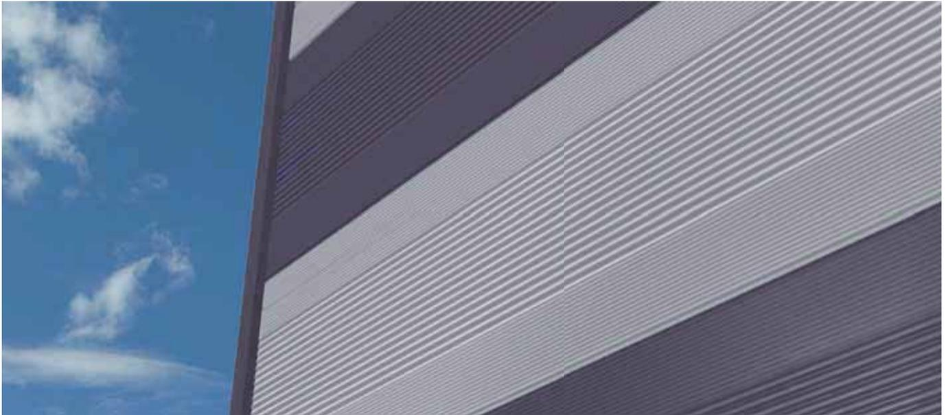
Panel de fachada de doble revestimiento metálico con aislamiento en poliuretano. La junta, con encastre machihembrado, es oculta, con tornillo pasante. Disponible en diferentes tipos de perfilado.
