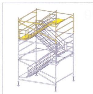
5- A continuación colocar dos **barandas centenellas** a lado y lado del tramo de escalera, ajustandose en los soportes indicados, soldados a la estructura del tramo de escalera.
