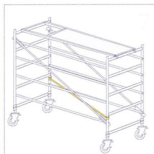
7- Colocar la **diagonal horizontal** mediante sus bridas: de la pata del primer marco en diagonal a la pata del marco opuesto, a la altura del segundo travesaño por abajo.
