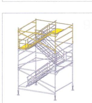
8- Ajustar dos **barandas rellano** en los soportes indicados de la estructura del tramo de escalera situados en los extremos del paso de cada tramo. Situar las dos **barandas centenella** en sus soportes.
