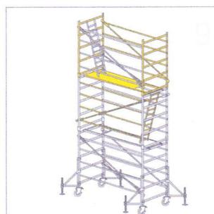
9- Seguir el montaje hacia arriba. En cada módulo colocar por orden: 2 **marcos de torreta**, 2 **diagonales verticales**, 8 **tirantes**, 1 **pasarela de escalera** de madera de 2 mt. con trampilla y 1 **escalera**, fijandola mediante sus palometas.
