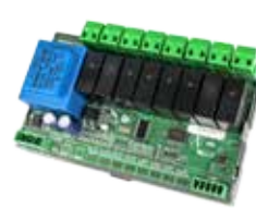
MÓDULO DE CONTROL DE ELEMENTOS RADIANTES
