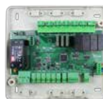
CENTRAL DE CONTROL DE EQUIPOS DE PRODUCCIÓN
