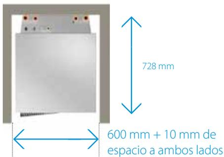
**3** Altura de instalación baja: tanto la versión de 180 l como la de 260 l del depósito de agua tienen una altura de 173 cm, lo que hace que la instalación tenga una altura total inferior a 2 m.
