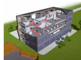
Aplicación Geotermia RWEYQ8-10T
