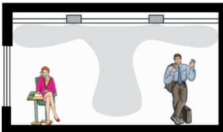
El aire de impulsión de uno y otro difusor chocan entre sí, provocando que el aire descienda a la zona ocupada antes de alcanzar las condiciones adecuadas de velocidad y temperatura.
