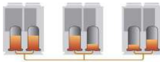
Tubería de equilibrado de aceite
