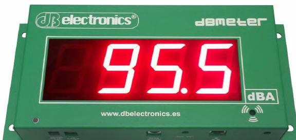
**Sonógrafo - Registrador** diseñado para el control y la evaluación del ruido. Su gran pantalla bicolor permite diferenciar tres ambientes sonoros: poco ruidoso, ruidoso y muy ruidoso. Con la ayuda de un buzzer puede emitir una señal acústica que avisa de la superación de un nivel de ruido preestablecido. Dispone de un puerto que, en función de tres franjas sonoras, puede controlar la acción de dispositivos externos, como por ejemplo una baliza.
