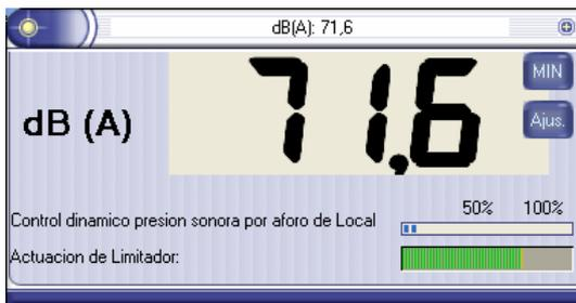
Software para Pc, con un sensor USB, muestra en la pantalla los decibelios en tiempo real, con posibilidad de envío de datos, por Internet. Información de aforo, y mensajes programables. Necesita de un PC, con windows minimo Xp, posibilidad de Pantalla exterior y varias zonas. Nivel de medición: 40 ~ 120 dB ( A ), se puede usar como sonografo registrador, o suplemento a limitadores que carecen de display.
