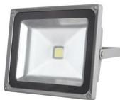
Proyector para uso comercial o escenario. Caja de aluminio fundido con cristal templado. Con aletas para una máx. disipación de calor. Soporte de montaje ajustable. Apto para el uso en exteriores (IP65). Incluye un cable de 30 cm. Alimentación: 230 VAC. Consumo máx.: 54 WLED: 50 W COB Epistar. Color de la caja: gris. Temperatura del color: 6500 K. Ángulo del haz: 120°. Flujo luminoso: 3000 lm. Cable: H05RN-F 3G1.0, 30 cm. Dimensiones: 285 x 234 x 141 mm. Peso: 2610 g.
