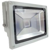
Foco LEDS. Alimentación AC 85-260 V 50/60Hz. Color luz Blanco Calido 3.500K, 2.700Lm. Duración 30.000h. Índice de protección IP65. Ángulo de visión 120°. Dimensiones 290 x 236 mm. Fabricado en Aluminio con cristal templado 5mm.
