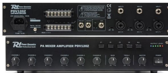
Sistema PA de seis canales, cuatro zonas diseñado para aplicaciones varias como paging, anuncios, intercomunicación, música ambiente, retransmisión en fábricas, etc. El sistema ofrece la posibilidad de enviar a diferentes zonas.
