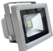
Foco LEDS. Potencia 10 W. Alimentación AC 85-260 V 50/60Hz. Color luz Verde. Índice de protección IP65. Duración 30.000h. Ángulo de visión 120°. Dimensiones 115 x 86 mm. Fabricado en Aluminio con cristal templado 5mm.
