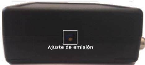
Su sistema de calibración permite programar un valor máximo de emisión que se encuentra entre los 45 y 95 db(A), con curva logarítmica a través de un potenciómetro de alta precisión situado a la derecha del aparato, el cual es totalmente precintable para evitar cualquier manipulación una vez fijado el máximo de
