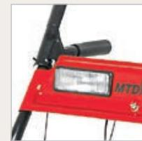
LUZ FRONTAL HALÓGENA EN LOS MODELOS SMART ME 61, OPTIMA ME 66, OPTIMA ME 66 T & OPTIMA ME 76
