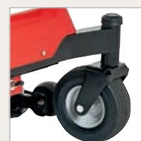
RUEDAS NEUMÁTICAS DELANTERAS GIRATORIAS
