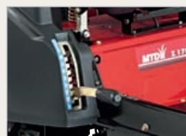
PALANCA ASISTIDA DE AJUSTE DE ALTURA DE CORTE
